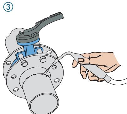
Die Rohrleitungsflansche mit elektr. Punkt-schweißung an die Rohrleitung anheften.
