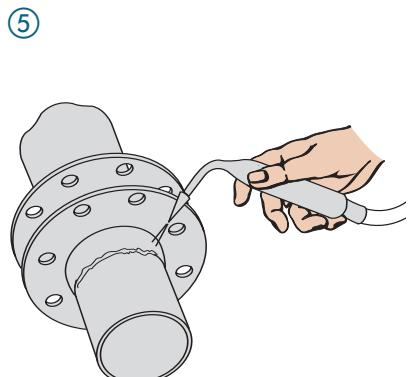
Flansche an die Rohrleitung anschweißen.
