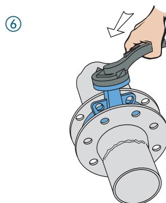
Nach dem Abkühlen der Flansche Absperrklappe einbauen. Die Armatur muss sich leicht zwischen die Flansche schieben lassen, damit die Manschette nicht beschädigt wird. Klappenscheibe leicht geöffnet lassen.
