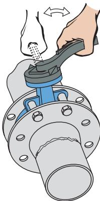
Klappenscheibe öffnen und prüfen, ob diese frei beweglich ist. Klappenscheibe leicht geöffnet lassen.
