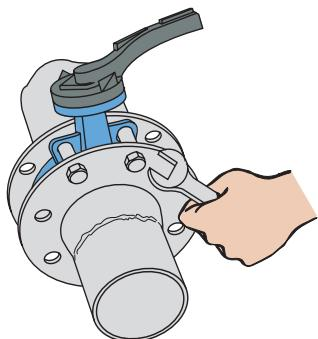
Absperrklappe ausrichten und 4 Flanschschrauben leicht anziehen.
