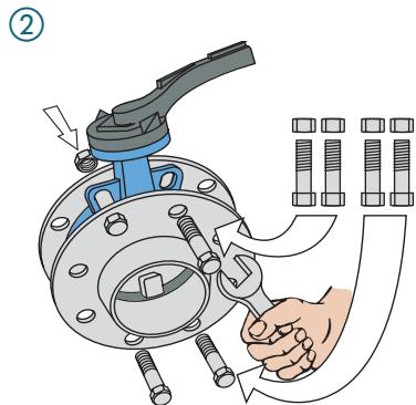
und mit 4 Flanschschrauben leicht anziehen und ausrichten.
